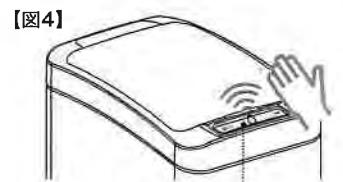
**センサーモード（自動開閉）** ディスプレイ・タッチパネル中央の上部約20cm以内に手をかざすとセンサーが反応し、円形にライトが点滅します。【図4】
