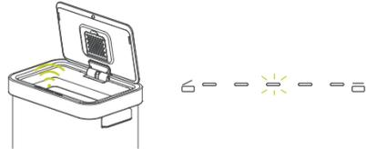
3 ふたユニット側面の電源スイッチで電源を落としてください。
